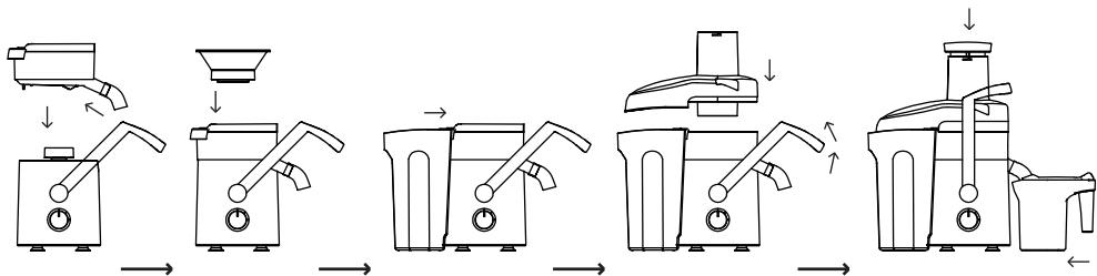
**Poznámka:** Při nesprávném nasazení a upevnění víka spotřebič nelze zapnout.
