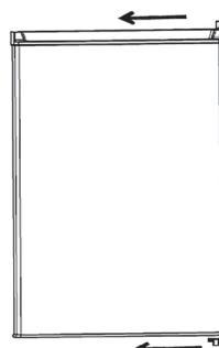
8) Svisle nasadte dvířka na spodní závěs. Upevněte horní závěs a horní kryt ledničky.
